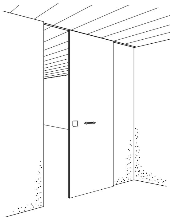
**Ferrure pour portes coulissantes jusqu'à 80 kg par vantail.**
