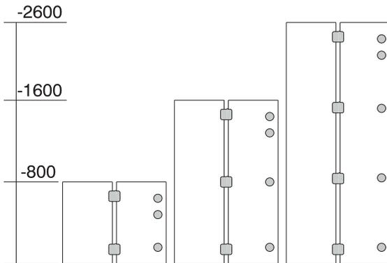
An der Aussenseite können handelsübliche Topfscharniere mit Feder,  $\leq 120^\circ$ , verwendet werden.
