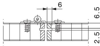
Ausräumung für vertikales Dichtungsprofil
