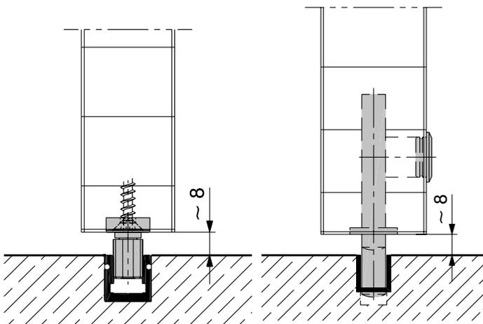
Bodenführungen und Führungsschienen mit Innenmass 10 mm
