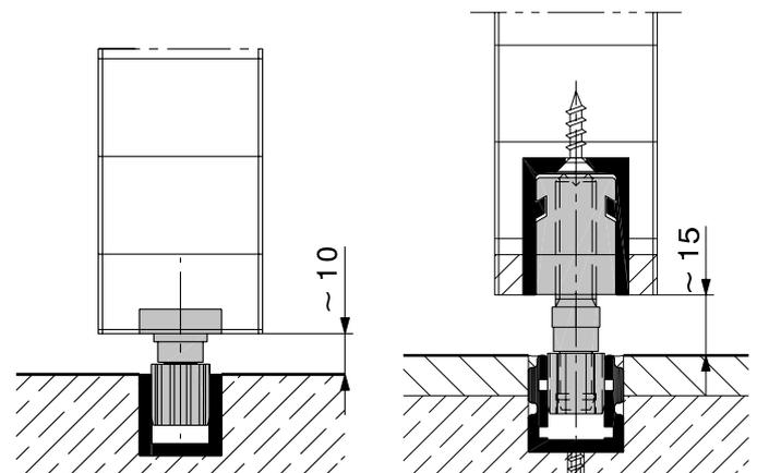
Bodenführungen und Führungsschienen mit Innenmass 14 mm
